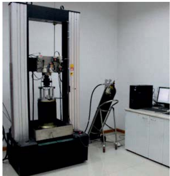
Testy Wytrzymałościowe / Air Spring Performance Test
