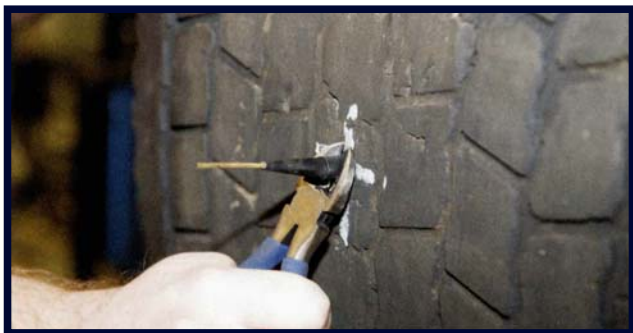
21. Nem feszített állapotban vágja le a felesleges szár-részt kb. (1/8") 3 mm a futófelület szintjében.
