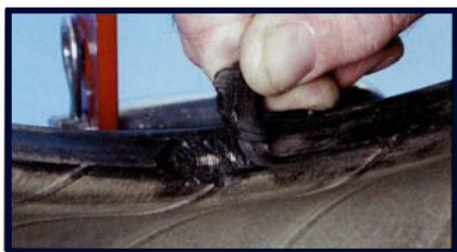
7. Deformálódott perem, kilátszó réteg vagy kord, acél-kord.
