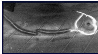
3. Butil (légzáró) réteg elválás.
