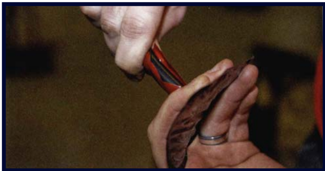
11. Távolítsa el a piros, műanyag védőfóliát a szárról, húzva és csavarva - ahogyan a képen látszik.
