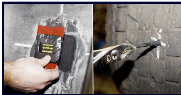
14. Tolja be a vezető tűskét a sérülésbe az abrondcs belseje felől. Fogja meg a tűskét egy fogóval és húzza keresztül a szárat a sérülésen addig, amíg a fej lazán felfekszik a felületre.
