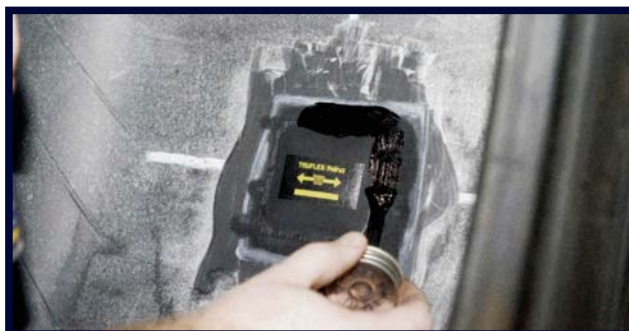
20. A fej széleit és a felhorzsolt részt kenje (tömítse) be Butil javító (BLRSF) oldattal.
