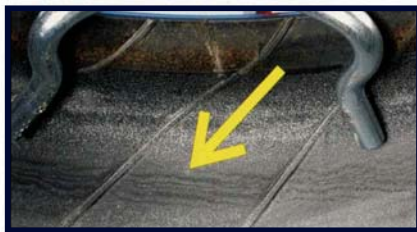
2. Ez a laposan vagy alacsony nyomáson futott acél radiál azt jelzi, hogy az abroncsot ki le kell selejtezni. (További információ: RMA Kiadvány).
