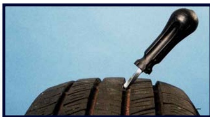
8. Ha a bemenő sérülés szöge meghaladja a 25 fokot, két részes javítóanyagot kell alkalmazni.
