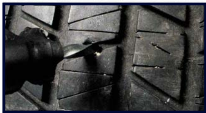
1. Személyabroncs esetében a sérülés nem lehet nagyobb, mint 1/4" (6 mm). Könnyű teher/teher abroncsnál maximum 3/8" (10 mm).
