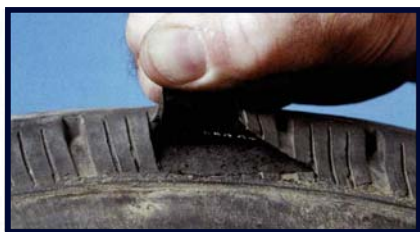
4. Váll réteg leválás.
