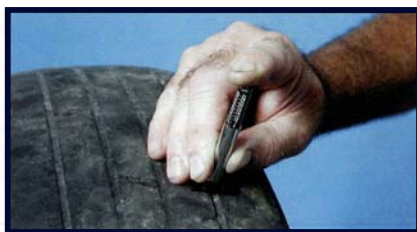
5. Túlságosan kopott futó-réteg.
